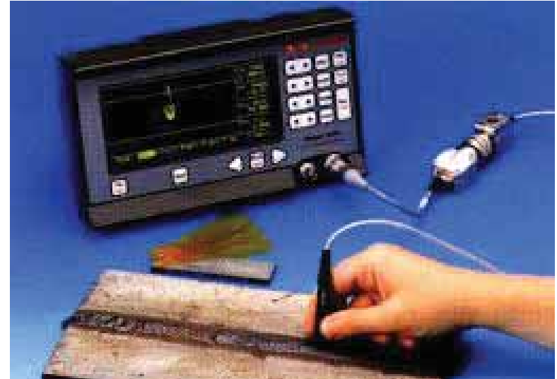
Ultrasonik Çatlak Testi
